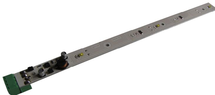
**Illuminatori a power led per installazione ad appoggio**
